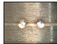
<溶接例 間隔 0.5mm>
